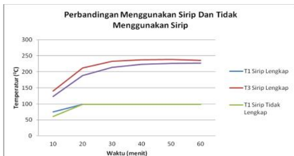
Gbr 11. Perbandingan Menggunakan Sirip Dan Tidak Menggunakan Sirip
